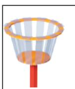
Пластиковый мерный стакан предназначен для измерения уровня выпавших осадков - дождя или снега.
