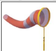
При сильном ветре конус надувается и вытягивается по горизонтали. Так он показывает две характеристики - метеорологическое направление ветра и его относительную силу.
